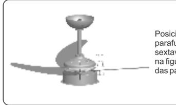
Posicione as pás abaixo das garras e fixe-as utilizando os parafusos francêss 4,8mm (3/16") x 12,7 (1/2") e as porcas sextavadas 4,8mm (3/16") x 7,9mm (5/16") como mostra na figura. Fique atento na indicação do lado de montagem das pás.
